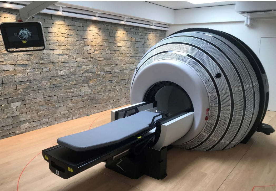
Beim Prinzip der Radiochirurgie treffen sich eine grosse Anzahl von Strahlen an einem Punkt, um den gewünschten radio-biologischen Effekt auszulösen. Das ZAP-X®-Gerät ist ein selbstabgeschirmter, gyroskopisch aufgehängter Linearbeschleuniger (ZAP surgical).
