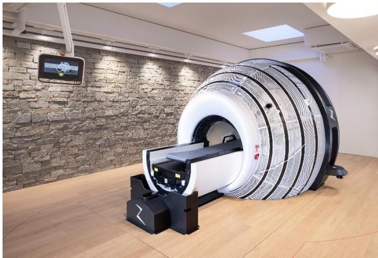
*Beim Prinzip der Radiochirurgie treffen sich eine grosse Anzahl von Strahlen an einem Punkt, um den gewünschten radio-biologischen Effekt auszulösen. Das ZAP-X®-Gerät ist ein selbstabgeschirmter, gyroskopisch aufgehängter Linearbeschleuniger (ZAP surgical).*
